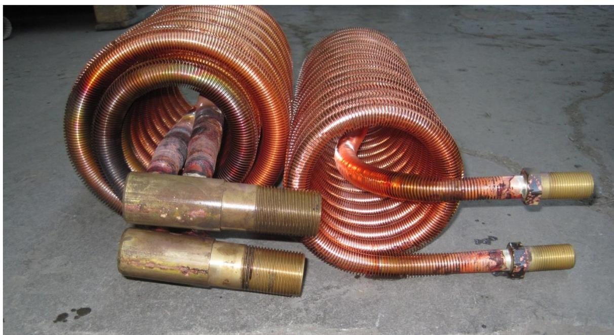
Figura 1: a sinistra serpentina disgiuntiva a due tubi, a destra serpentina per sanitario
